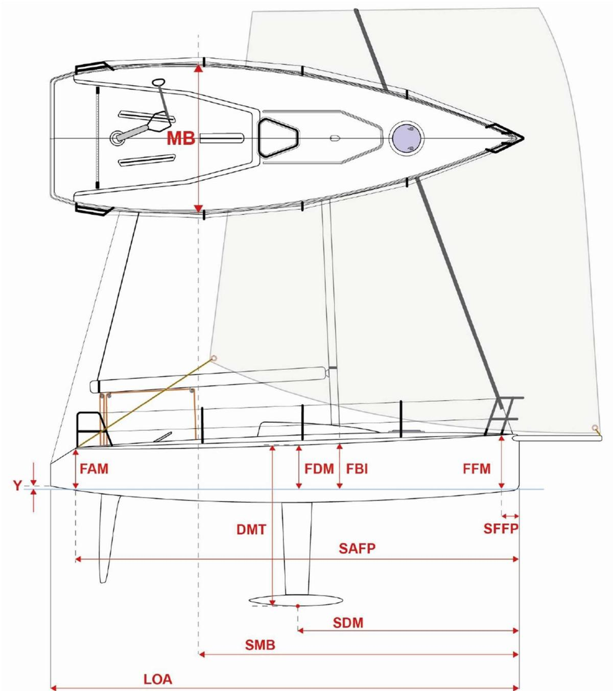
En cualquiera de las categorías, se permite fibra de carbono cubriendo bordes de estructuras “bona fide” del casco, como cuadernas, palmejares y como refuerzo localizado para fijación de los cadenotes, con tal que estén bajo cubierta entre  $0,3 * LOA$  y  $0,7 * LOA$  a popa de la roda.
